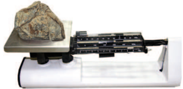
الشكل ١٢ يستخدم الميزان الثلاثي الأذرع لقياس كتلة جسم.
