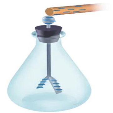
لشحن كشاف كهربائي عن طريق التوصيل. لمس قرص الكشاف الكهربائي بساق معدني مشحون.
