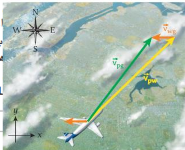
الشكل 3.19 السرعة المتجهة لطائرة بالنسبة إلى الرياح (باللون الأصفر)، والسرعة المتجهة للرياح بالنسبة إلى الأرض (باللون البرتقالي)، والسرعة المتجهة المحصلة للطائرة بالنسبة إلى الأرض (باللون الأخضر).
