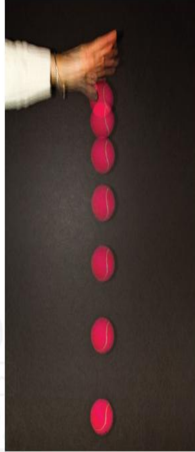
الشكل 20 تزداد سرعة هذه الكرة الساقطة بمعدل 9.8\text{ m/s} كل ثانية بفعل تسارع السقوط الحر.
