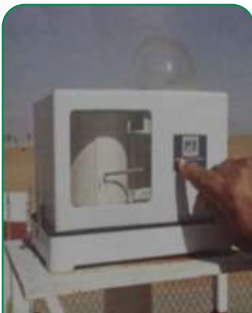
الترموجرف قياس درجة حرارة الهواء
