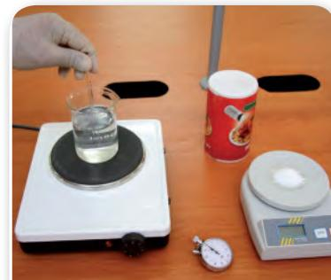
**الشكل 1-11** هذه المواد يمكن أن تستعمل لقياس أثر درجة الحرارة في سرعة ذوبان ملح الطعام.
