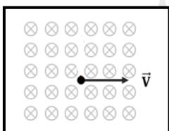
مجال مغناطيسي منتظم مقداره T (0.2) واتجاهه عمودياً داخل الورقة دخل هذا المجال المغناطيسي جسم مشحون بشحنة C μ (2) وبسرعة منتظمة  $v = 200 \text{ m/s}$  وباتجاه مواز لسطح الورقة باتجاه اليمين كما بالشكل المجاور .
