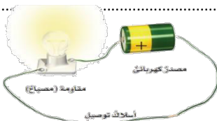
أجزاء الدائرة الكهربائية
