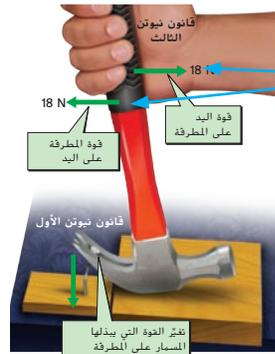
**اطرح السؤال:** كيف يوضح قانون نيوتن الثالث في الرسم التوضيحي الأول الموجود في الشكل 20؟ تعرض الأسهم الخضراء قوى متعادلة مقدارها  $18\text{ N}$  تؤثر في اتجاهات مضادة.
