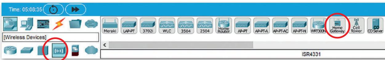
المودم هو جهاز يوصل جهاز الحاسب أو جهاز توجيه بالإنترنت من خلال استخدام الكابلات، ويتلقي المودم معلومات من مزود الخدمة (ISP) عبر خطوط الهاتف أو الألياف الضوئية أو الكابل المحوري ويتحولها إلى إشارة رقمية.
