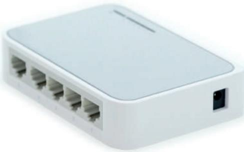
الموزع جهاز يصل عدة أجهزة داخل الشبكة المحلية، عندما يستقبل الموزع حزمة بيانات من جهاز متصل به، فإنه يبث هذه الحزمة إلى جميع الأجهزة المتصلة الأخرى بصرف النظر عن وجهتها النهائية.
