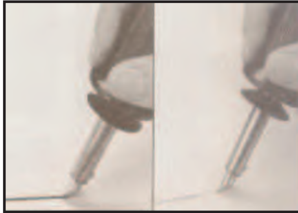
الشكل (٦٨): تحديد عمق الضغط بالقلم.
