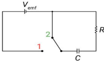
يحدث التفريغ عند توصيل مكثف مشحون مع مقاوم بدون وجود البطارية كما بالشكل .
