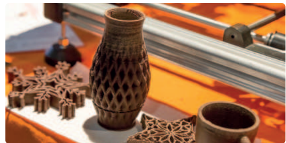
شكل 3.12: الطباعة ثلاثية الأبعاد بمادة السيراميك
