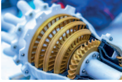
شكل 3.17: محرك نفثات مطبوع على شكل نموذج بلاستيكي معدني
