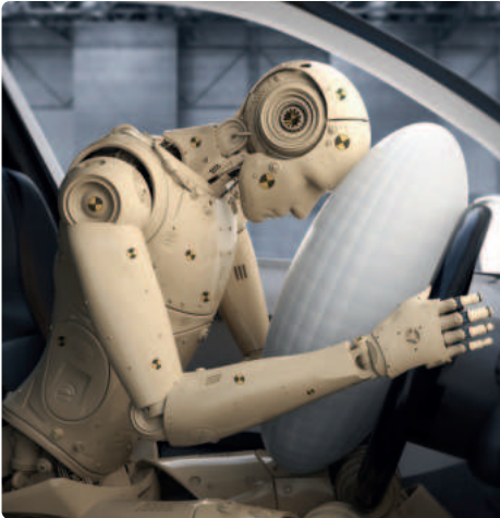
شكل 2.8: اختبار التصادم باستخدام دمية ثلاثية الأبعاد
