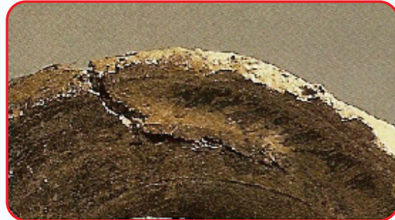
شكل ( ٥٢ ) : يوضح نتائج أخطاء التجفيف ( تشقق ).
