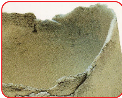
شكل ( ٥٢ ) : يوضح نتائج أخطاء التجفيف ( تشقق ).
