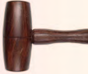
الشكل ( ٦٠ ) : مطارق متنوعة ومتعددة ذات رؤوس خشبية مناسبة للحفر.
