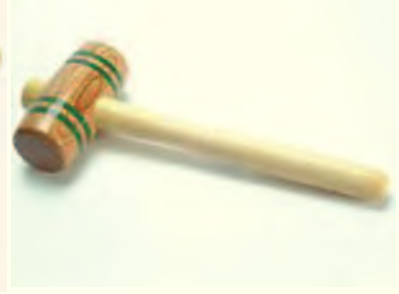
الشكل ( ٦٠ ) : مطارق متنوعة ومتعددة ذات رؤوس خشبية مناسبة للحفر.
