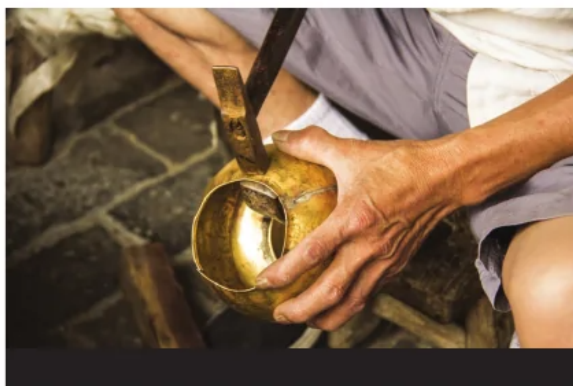
الشكل 13 إنّ الفلزات الصلبة، مثل النحاس، قابلة للطرق، أمّا اللافلزات الصلبة، مثل الكبريت، فهي هشة.
