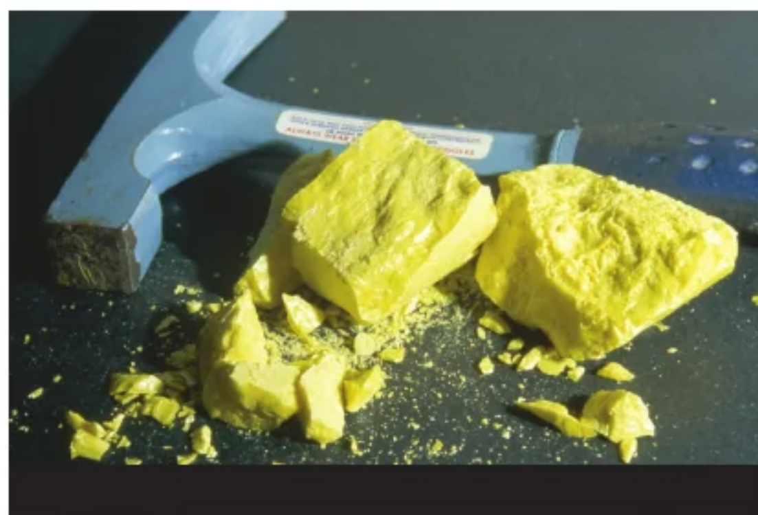
الشكل 13 إنّ الفلزات الصلبة، مثل النحاس، قابلة للطرق، أمّا اللافلزات الصلبة، مثل الكبريت، فهي هشة.
