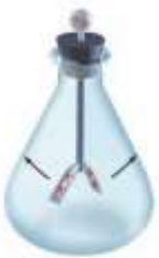
عند زرع التأريض عن الكشاف الكهربائي قبل إزالة الساق، فإن الشحنة الموجبة في الكشاف الكهربائي.
