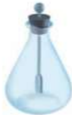
الكشاف الكهربائي المتعادل ينتج توزيع متعادل للشحنات وتنتهي الفولتان على نحو حر.
