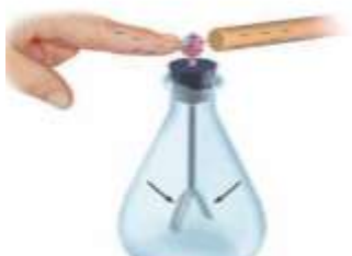
ملامسة الكشاف الكهربائي تسحب الساق المشحون بدفع الإلكترونات للخروج إلى اليد بدلاً من الأسفل إلى الفولتان.
