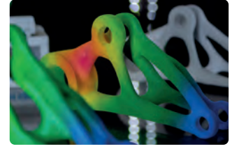
شكل 3.6: نموذج مطبوع باستخدام عملية الربط الطبقي
