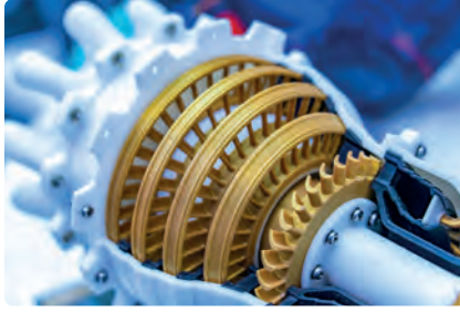
شكل 3.17: محرك نفث مطبوع على شكل نموذج بلاستيكي معدني
