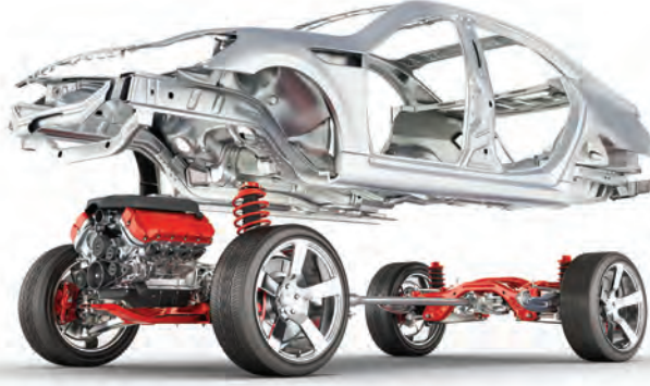
شكل 2.21: عرض تفصيلي لتجميع سيارة
