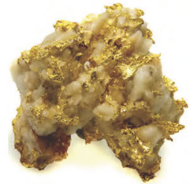
الشكل 36-4 تتكون عروق الذهب في الكوارتز عندما يبرد المحلول الحراري المائي.
