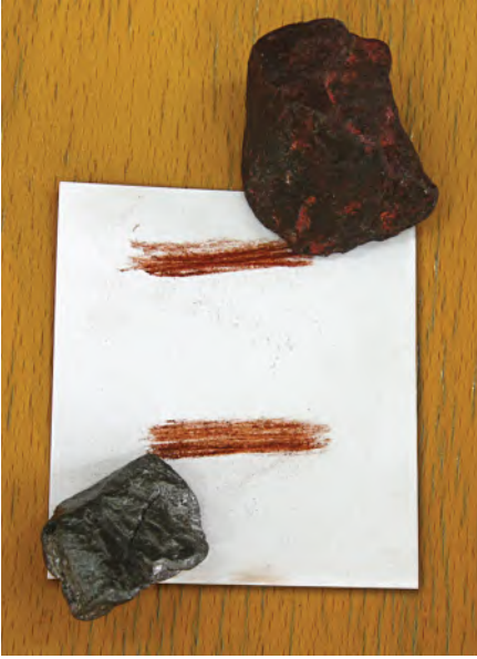
الشكل ٦ المخدش هو لون مسحوق المعدن. معدن الهيماتيت له مخدش بني محمر. وضح كيف تحصل على مخدش معدن؟
