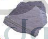
سطح البناء مصنوع من صخر الأردواز الذي يُصنف على أنه صخر متحول متورق.
