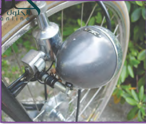
يتصل المولد الكهربائي بعجلة الدراجة
