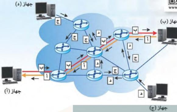
شكل (٤-١) تقنية التبدل للدوائر التخيلية
