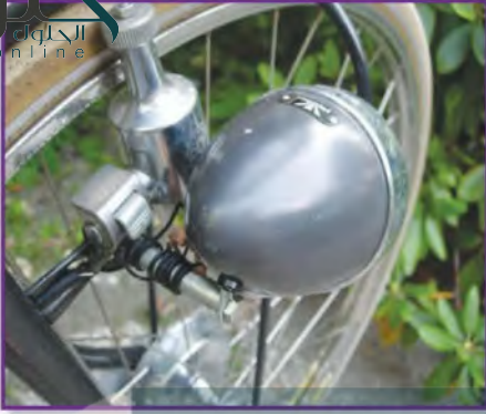
يتصل المولد الكهربائي بعجلة الدراجة
