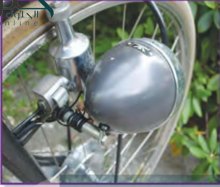
يتصل المولد الكهربائي بعجلة الدراجة
