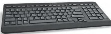
**لوحة المفاتيح (Keyboard)** هي إحدى أهم أجهزة الإدخال للحاسوب، حيث يمكن للمستخدم من خلالها إدخال النصوص وإعطاء الأوامر للحاسوب.
