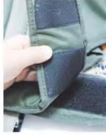
تستعمل ألياف النايلون في صناعة أشرطة التثبيت.
