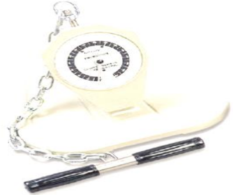
شكل (٢) جهاز ديناموميتر لقياس قوة عضلات الفخذين والظهر
