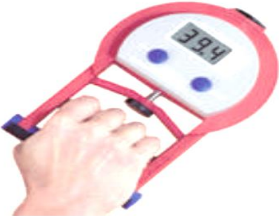
شكل (٣) جهاز ديناموميتر لقياس قوة القبضة
