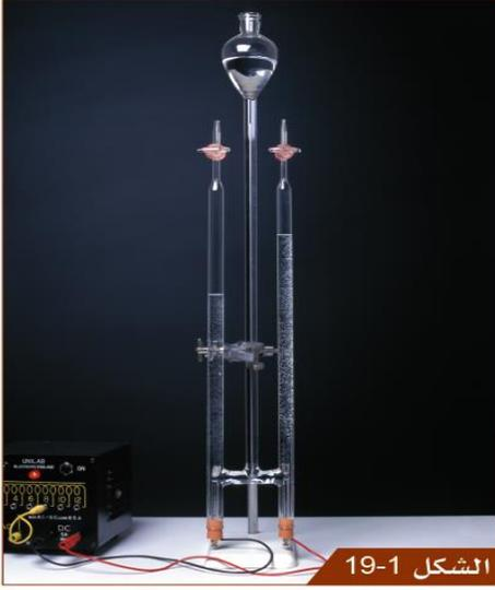
عند إجراء تحليل كهربائي للماء بواسطة جهاز فولتامتر هوفمان فإن جزيء الماء يتفكك لعناصره المكونة له وسنحصل على حجم غاز الهيدروجين ضعف حجم غاز الأكسجين
