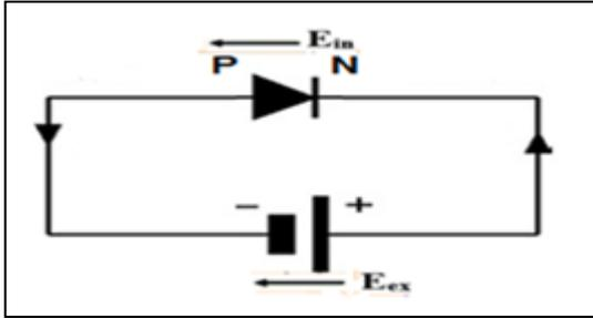
هـ - امامك دائرة كهربية متصل بها وصلة ثنائية ( دايود ) و مصباح كهربى , وضح ماذا يحدث لأضاءة المصباح الكهربى فى كل حالة من الحالات التالية مع ذكر السبب :
