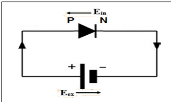
**د- طريقة توصيل الانحياز العكسي للوصله الثنائية موضحا اتجاه المجالات الكهربيه داخل وخارج الوصله واتجاه حركة حاملات الشحنة واتجاه التيار الكهربى الاصطلاحي**
