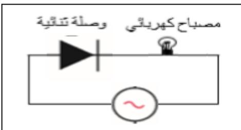
**و- كيفية استخدام الوصلة الثنائية (P/N) في تقويم التيار الكهربائي المتردد تقويم نصف موجي مع توضيح الاجابة برسم الدائرة المستخدمة وشكل منحني التيار قبل وبعد التقويم**
