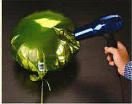
الشكل 9 يزداد حجم الهواء الموجود داخل البالون بزيادة درجة الحرارة.
