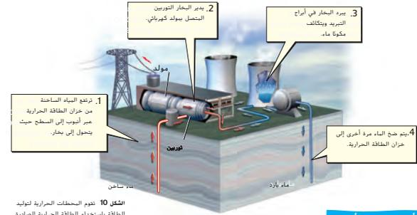
الشكل 10 تقوم المحطات الحرارية لتوليد الطاقة باستخدام الطاقة الحرارية الصادرة عن باطن الأرض لتوليد الكهرباء.
