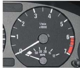
الشكل 9.9 يقيس عداد السرعة في سيارة ما تردد دورات المحرك (عدد الدورات في الدقيقة).
