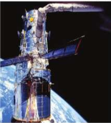
الشكل 7 يتحكم علماء الفلك على الأرض في تلسكوب "هابل" الفضائي. وهو تلسكوبًا عاكسًا يدور حول الأرض. ويبلغ قطر مرآته الرئيسة 2.4 m. يرسل تلسكوب هابل إلى الأرض بصورة دورية صورة مذهلة لأجسام بعيدة للغاية.
