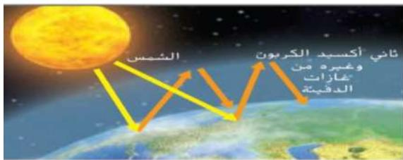
الشكل 19 تتصدى غازات الدفيئة للطاقة الحرارية من الشمس ثم تُعيد إشعاعها وتؤدي إلى تدفئة سطح الأرض.
