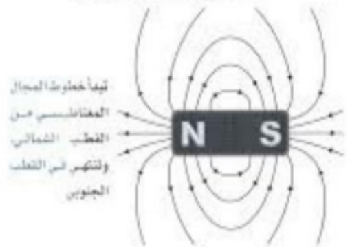
للمساعدة برادة الحديد على إظهار خطوط المجال المغناطيسي حول قضيب مغناطيسي.
