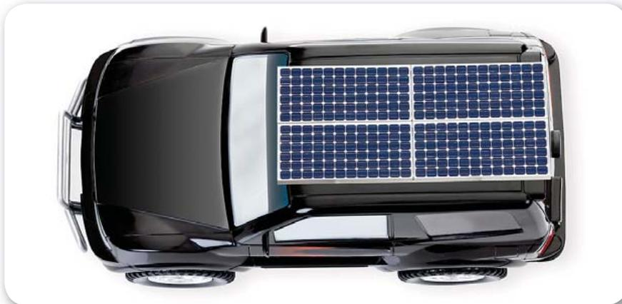
■ **الشكل 17** تُحوّل الخلايا الكهروضوئية الطاقة الإشعاعية إلى طاقة كهربائية. لبعض المركبات ألواح كهروضوئية اختيارية مصنوعة من خلايا شمسية تُستخدم لتبريد السيارة من دون استخدام المحرك.
