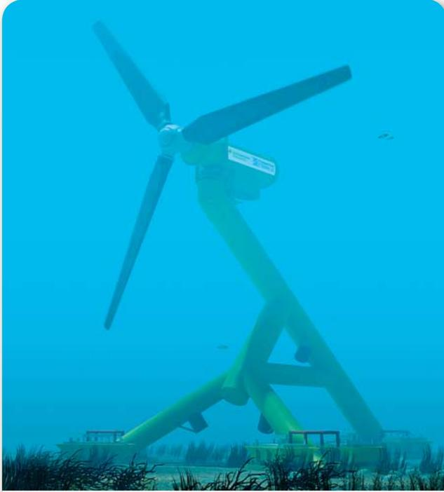
■ الشكل 21 في ولاية فلوريدا، يُقدّر الباحثون أنّ التوربينات التي تقع تحت الماء والتي تُديرها التيارات الناتجة عن تيار الخليج يمكنها توليد ما يعادل قيمة إنتاج عشر محطات لتوليد الطاقة النووية من الكهرباء.
