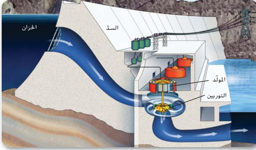
■ الشكل 19 تتحوّل طاقة الوضع الجذبية الماء الموجود خلف السد إلى طاقة كهربائية في إحدى محطات الطاقة الكهرومائية. اشرح تحوُّلات الطاقة التي تحدث أثناء توليد السد الكهرومائي للطاقة الكهربائية.
