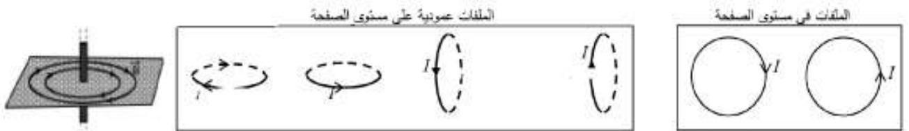
ملاحظة : ينعكس اتجاه المجال المغناطيسي عند عكس اتجاه التيار .
