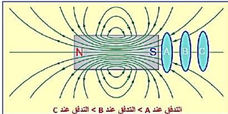
التدفق عند A < التدفق عند B < التدفق عند C
