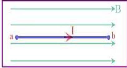
2- في الشكل المجاور إذا كانت شدة التيار المار في السلك ( ab ) (3.0A) ومقدار المجال المغناطيسي ( 0.03T ) فإن مقدار القوة المغناطيسية المؤثرة في وحدة الأطوال من السلك تساوي:
