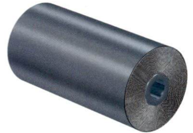
الشكل 4.4 يمكن لف الرقاقتان المعدنية وشطيرة المايلاز الموضّحة في الشكل 4.3 بطبقة عازلة لإنتاج مكثف ذي شكل هندسي مدمج.
