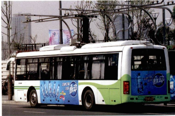
الشكل 4.33 حافلة تعمل بالمكثف الفائق تجري إعادة شحنها في موقف حافلات في شنغهاي بالصين.
