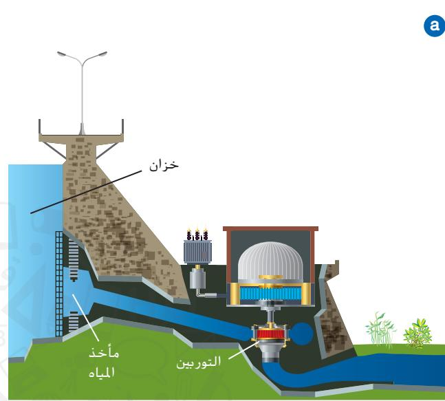
**الشكل 2** يوضح إمكانية تغير الطاقة من شكل إلى آخر ولكن مع الاحتفاظ بها دوماً. في **a** تم تحويل طاقة وضع الماء إلى طاقة حركية حيث تسقط خلال سحبها من مكانها المرتفع في الخزان. يؤدي الماء المندفع إلى دوران التوربينات لتوليد الطاقة الكهربائية. في **b** يتم تحويل طاقة الوضع المخزنة في روابط جسيمات البروبان إلى حرارة.
