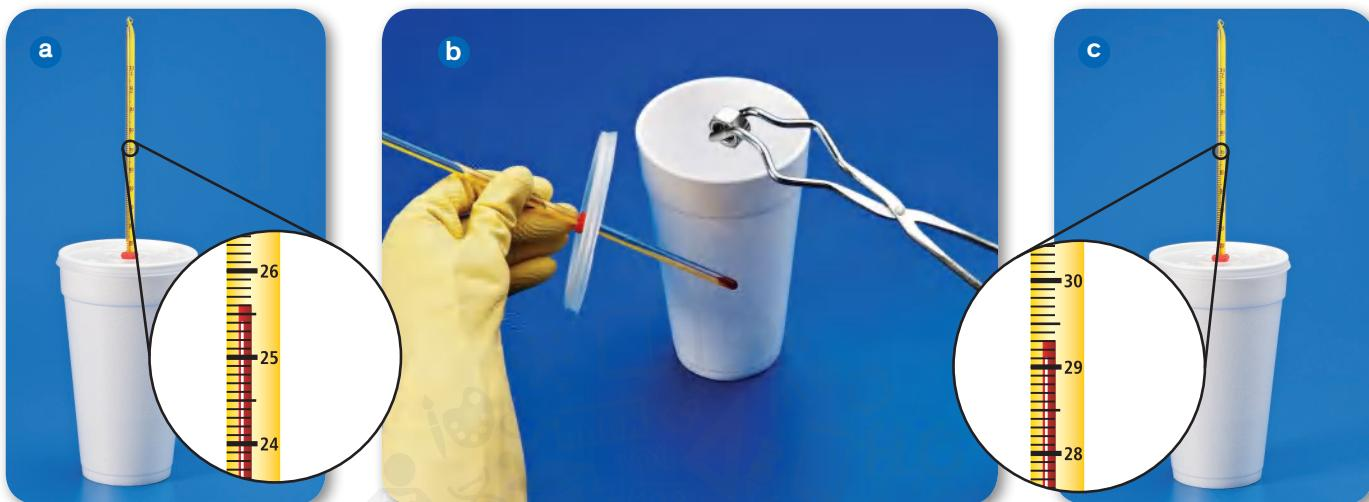
**الشكل 6** يوضح إجراء التجربة. لاحظ أن درجة الحرارة في المُسّغر أصبحت ثابتة عند  $29.30^{\circ}\text{C}$ . وهي درجة الحرارة النهائية لكل من الماء والفلز. بافتراض عدم فقدان أي حرارة وانتقالها للوسط المحيط، فإن مقدار الحرارة التي اكتسبها الماء متساوية لمقدار الحرارة التي فقدتها الفلز. يمكن حساب كمية الحرارة باستخدام المعادلة التي تعلمتها في القسم 1.
