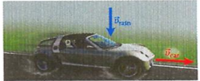
الشكل 3.19 متجهي سرعة لسيارة متحركة والمطر المتساقط عليها بصورة مستقيمة، وفقًا لما يراه مراقب ثابت.
