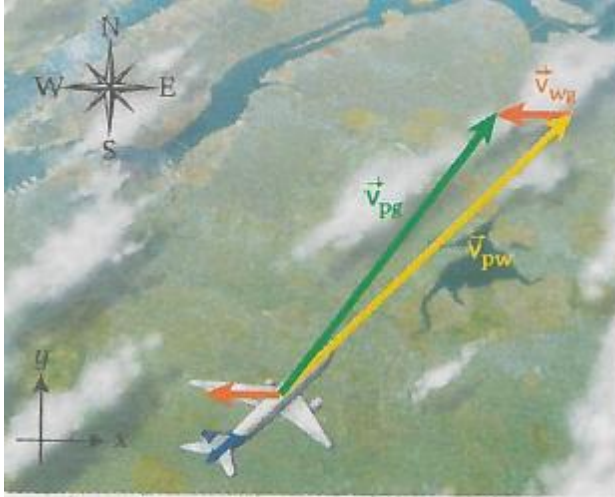
الشكل 3.18 السرعة المتجهة لطائرة بالنسبة إلى الرياح (باللون الأصفر)، والسرعة المتجهة للرياح بالنسبة إلى الأرض (باللون البرتقالي)، والسرعة المتجهة المحصلة للطائرة بالنسبة إلى الأرض (باللون الأخضر).
