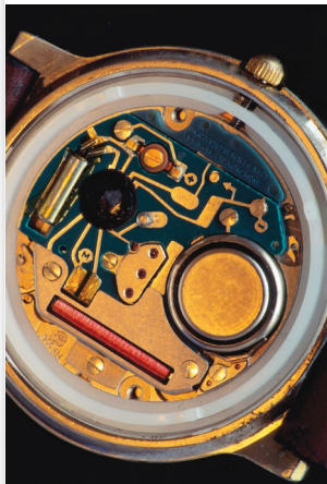
وعلى الرغم من أنها تبدو مختلفة إلا أن بطارية الفضة تشبه كثيرًا البطارية القلوية. تستخدم بطارية الفضة، أكسيد الفضة (Ag 2 O) ككاثود بدلاً من أكسيد المنغنيز (IV) (MnO 2 ).
